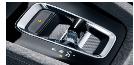
SHIFT-BY-WIRE Elektroniczne sterowanie skrzynią biegów DSG
