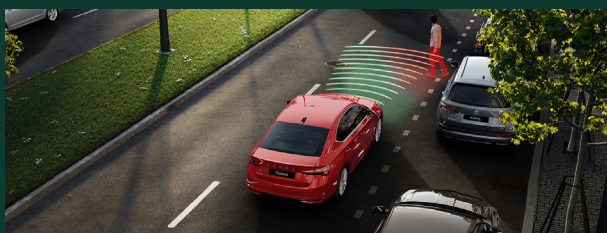
Front Assist – kontrola odstępu z funkcją awaryjnego hamowania
