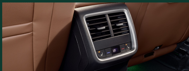
Climatronic automatyczna 3-strefowa klimatyzacja z regulacją elektroniczną
